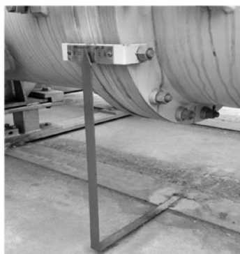
图3 标尺监测母线筒体轴向位移
